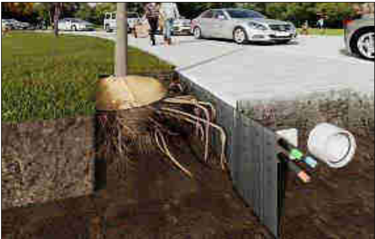
Schema dell'effetto della barriera radicale dopo la sua installazione.
